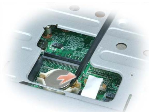
Pour mettre une nouvelle pile en place, insérez-la à un angle de 30 degrés sous le clip, côté positif (identifié par le signe plus [+]) vers le haut, puis appuyez dessus pour la mettre en place.
